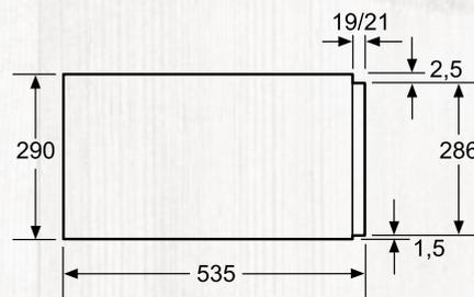
Sopra uno scaldavivande possono essere installati forni con un'altezza apparecchio di 595 mm. Non è necessario un ripiano intermedio.
