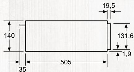
Sopra uno scaldavivande possono essere installati forni compatti con un'altezza apparecchio di 455 mm. Non è necessario un ripiano intermedio.
