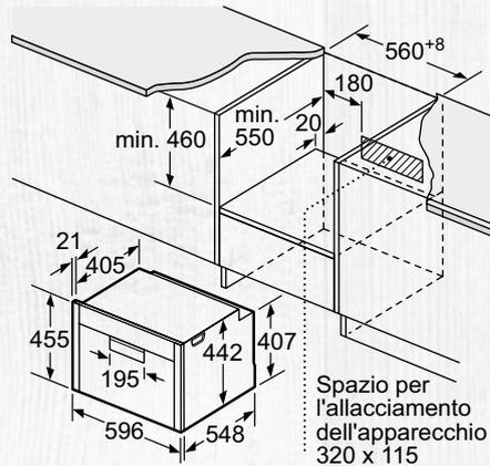
Se l'apparecchio compatto viene montato sotto un piano di cottura deve essere rispettato il seguente spessore del piano di lavoro (event. incl. sottostruttura).
