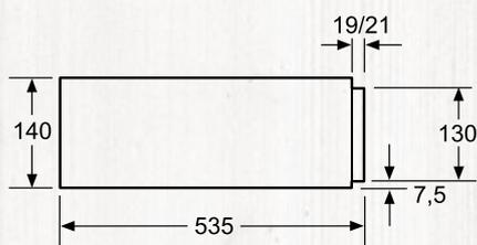
Sopra uno scaldavivande possono essere installati forni compatti con un'altezza apparecchio di 455 mm. Non è necessario un ripiano intermedio.
