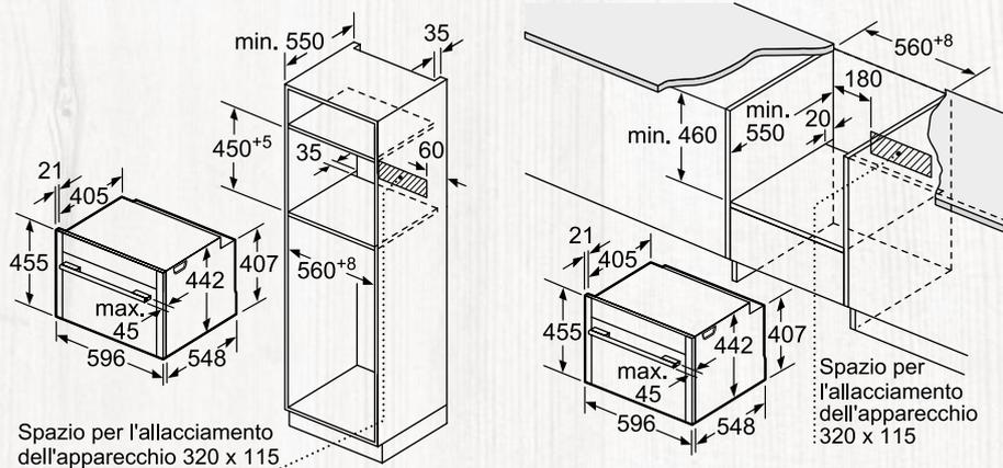
Se l'apparecchio compatto viene montato sotto un piano di cottura deve essere rispettato il seguente spessore del piano di lavoro (event. incl. sottostruttura).
