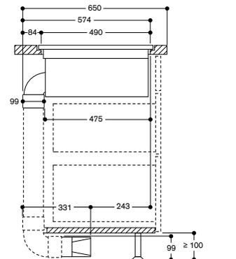
Vista laterale di CV 492 / CV 282 con ricircolo canalizzato (CA 082 020) e connettore piatto extra-corto con piega a 90° (AD 857 034)
