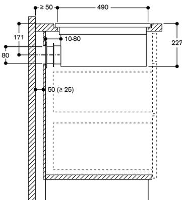
Per installazioni che prevedono il ricircolo dell'aria verso pareti posteriori non sufficientemente isolate (Trasmittanza termica  $U \geq 0.5 \text{ W/m}^2\text{°C}$ ) si raccomanda una progettazione di tipo canalizzato.
