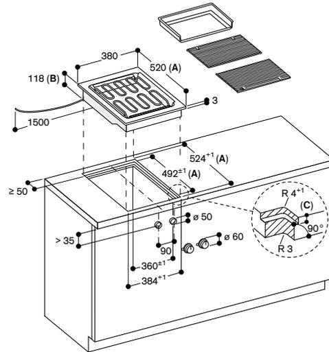
A: Se si installa con il coperchio VA 440 prendere in considerazione lo spazio aggiuntivo richiesto per la profondità. Osservare le precauzioni di montaggio separate
