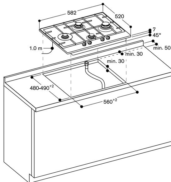
\* 56 mm di spazio per connessione gas lato posteriore destro
