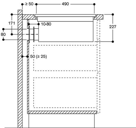
Per installazioni che prevedono il ricircolo dell'aria verso pareti posteriori non sufficientemente isolate (Trasmittanza termica  $U \geq 0.5 \text{ W/m}^2\text{°C}$ ) si raccomanda una progettazione di tipo canalizzato.
