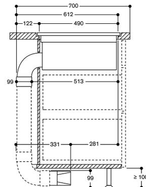
Vista laterale di CV 492 / CV 282 con ricircolo canalizzato (CA 082 020) e connettore piatto corto con piega a 90° (AD 857 033)
