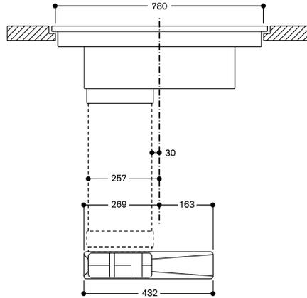
Vista laterale di CV 492 / CV 282 con ricircolo canalizzato (CA 082 020) e connettore piatto standard con piega a 90°
