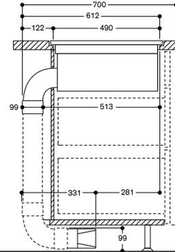
Vista laterale di CV 492 / CV 282 con ricircolo canalizzato (CA 082 020) e connettore piatto corto con piega a 90° (AD 857 033)
