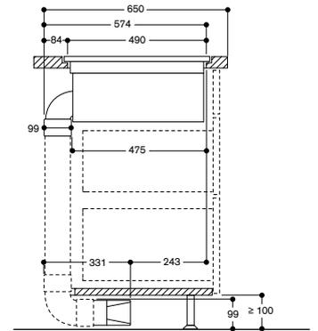
Vista laterale di CV 492 / CV 282 con ricircolo canalizzato (CA 082 020) e connettore piatto extra-corto con piega a 90° (AD 857 034)
