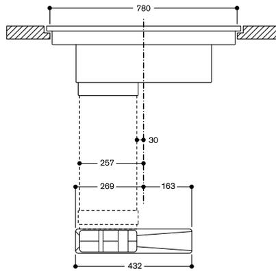
Vista laterale di CV 492 / CV 282 con ricircolo canalizzato (CA 082 020) e connettore piatto standard con piega a 90°
