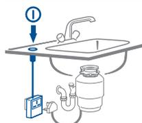
**Interruttore pneumatico completo** (basetta con presa + pulsante pneumatico + tubicino 1,5 m)
