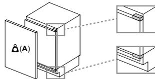
I frontali montati dell'unità che superano il peso consentito possono causare danni e compromettere il funzionamento delle cerniere
