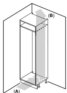
A: Ingresso aria  $\geq 200$  cm<sup>2</sup>; opzioni di ventilazione
