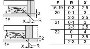
Le distanze consigliate nella tabella vanno mantenute per garantire un'apertura senza collisioni delle porte degli apparecchi ed evitare danni al mobile della cucina.
