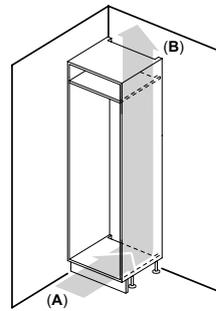
A: Ingresso aria  $\geq 200$  cm<sup>2</sup>; opzioni di ventilazione
