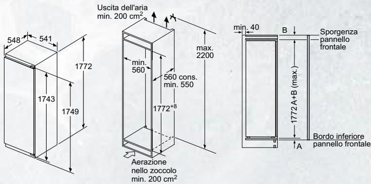
A: Ingresso aria  $\geq 200 \text{ cm}^2$ ; opzioni di ventilazione
