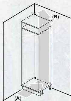
A: Ingresso aria  $\geq 200 \text{ cm}^2$ ; opzioni di ventilazione
