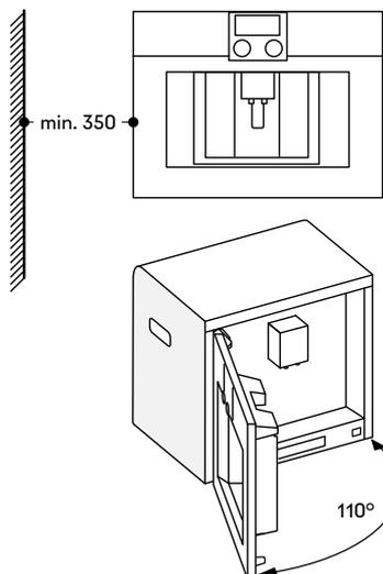
Se si utilizza il limitatore della cerniera della porta a 92° (ricambio n. 00 636 455), la distanza minima dalla parete è di soli 100 mm.
